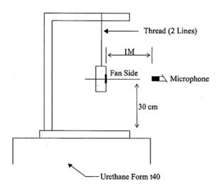
1 METER FROM MICROPHONE TO FAN INTAKE
