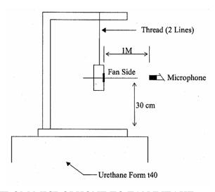
1 METER FROM MICROPHONE TO FAN INTAKE
